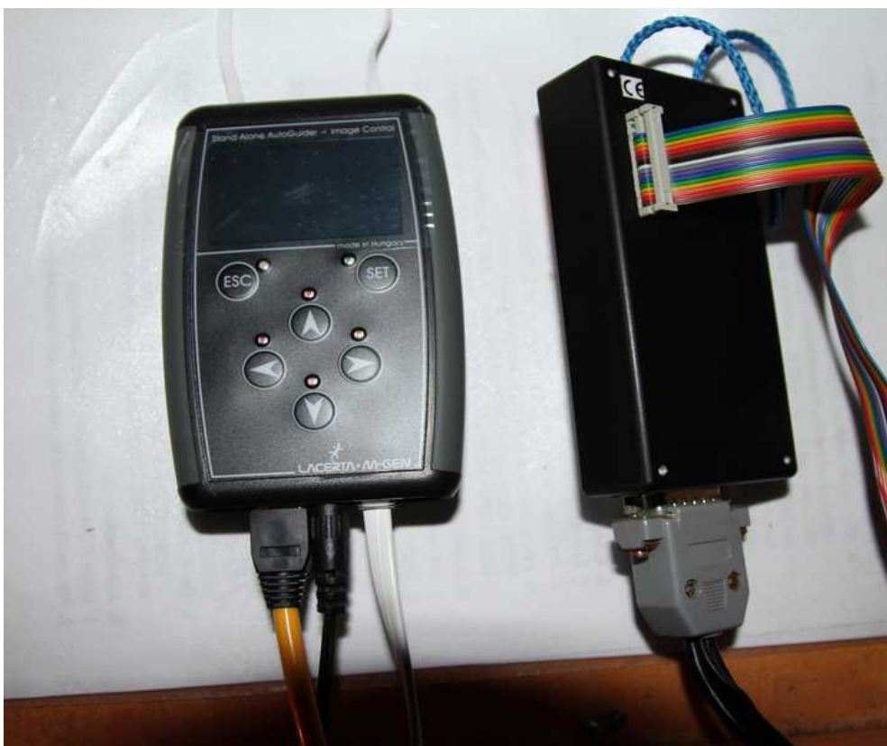
Bild: Handbox (links) des Autoguiders und Rückseite der Teleskopsteuerung (rechts)
