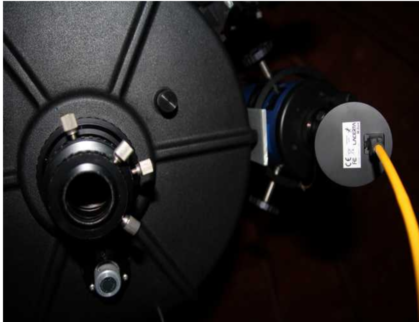
Bild: C14 Okularauszug (links) und Autoguiderkamera (rechts). Die Kamera sollte zum Teleskop gedreht sein, um die bestehende Kalibrierung nutzen zu können.
